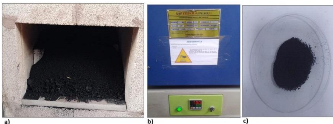
Figura 2. (a) Colocación de la ceniza en la mufla, (b) Horno para la calcinación, (c) CGD calcinados a 700 °C. Fuente: los autores
