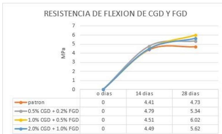
Figura 4. Resultado del ensayo a flexión a los 7, 14 y 28 días. Fuente: los autores
