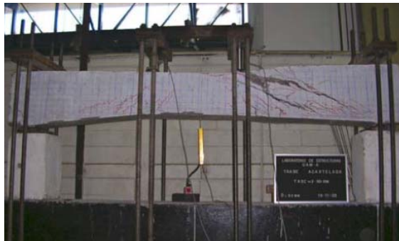
Figura 19. Evolución del agrietamiento de la trabe TASCα3-R0-RM.
