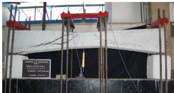
Figura 21. Evolución del agrietamiento de la trabe TASCα4-R0-RM.
