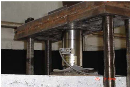
b) Detalle de una de las celdas de carga
