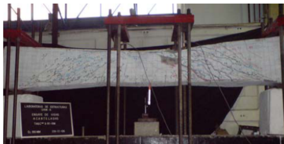
Figura 20. Evolución del agrietamiento de la trabe TASCα3-R1-RM.
